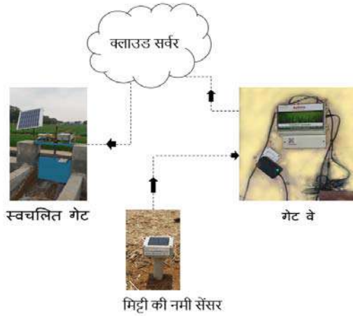
चित्र 2: मिट्टी की नमी सेंसर और स्वचालित चेक गेट के बीच वायरलेस संचार
