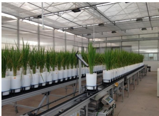
छायाचित्र-3: नानाजी देशमुख प्लांट फिनोमिक्स केंद्र में पौधों के लिए वाहक तंत्र (बाएं) एवं छविचित्रण हेतु विभिन्न प्लेटफार्म (दाएं)
