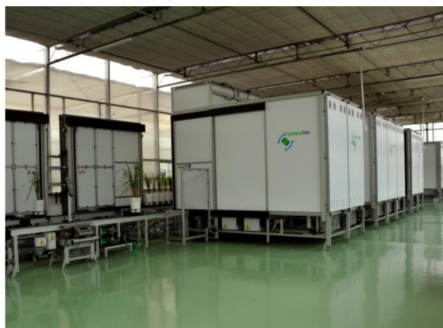
छायाचित्र-3: नानाजी देशमुख प्लांट फिनोमिक्स केंद्र में पौधों के लिए वाहक तंत्र (बाएं) एवं छविचित्रण हेतु विभिन्न प्लेटफार्म (दाएं)
