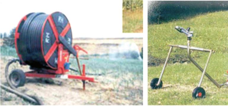
**Fig. 5.10: Travelling rain gun**
